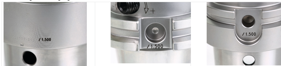
Abb. 5: Beschriftung zur Prüfung der Spannkraft: Drei mögliche Positionen auf dem Spannfüter
