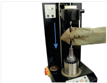
Abb. 8: Werkzeug in Aufnahmebohrung einführen
