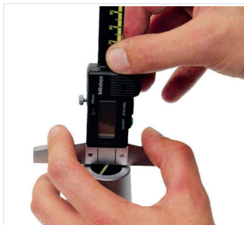
Abb. 6: Schrumpffutter auf Werkzeuglänge einstellen
