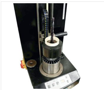
Abb. 10: Schrumpffutter mit Werkzeug erwärmen
