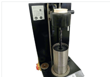
Abb. 9: Schrumpffutter mit Werkzeug abkühlen
