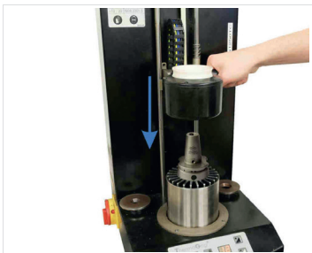
Abb. 7: Schrumpffutter mit Schrumpfgerät erwärmen
